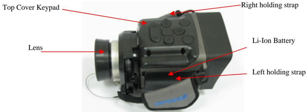
**Figure 2: EYE-C-GAS, main parts**
